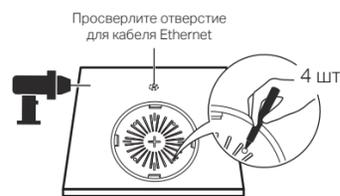
2 Разместите крепление в середине потолочной плитки. Обозначьте места, в которых будут просверлены отверстия для винтов и кабеля Ethernet. Просверлите в обозначенных местах четыре отверстия для винтов диаметром 4 мм, а также отверстие диаметром 25 мм для кабеля Ethernet.
